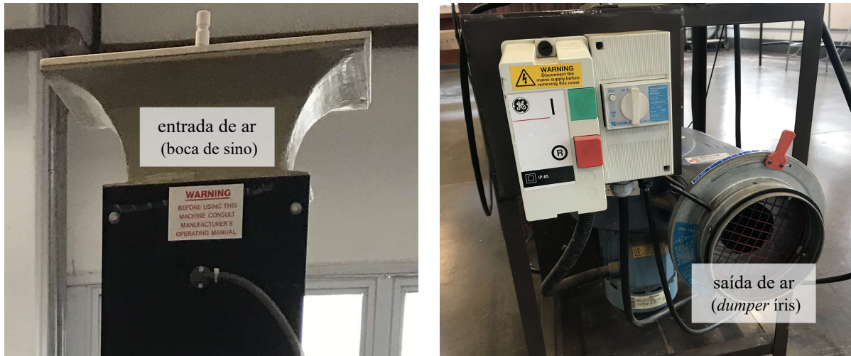
Figura 2. Fluxo de ar ocasionado por ventilador de rotação variável.
