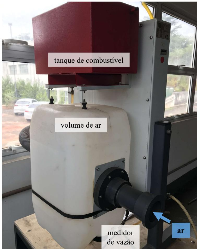
Figura 3. Detalhe do reservatório de combustível e do ponto de sucção do ar ambiente.
