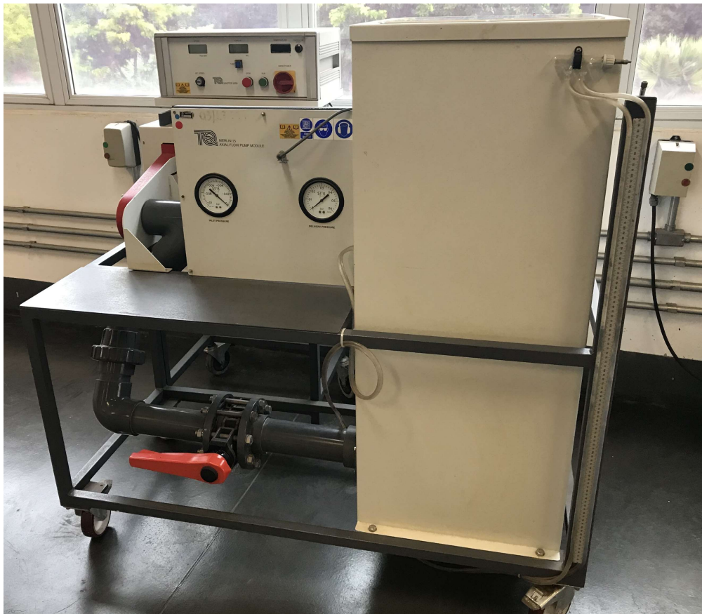
Figura 1. Fotografia do sistema experimental com bomba axial.
