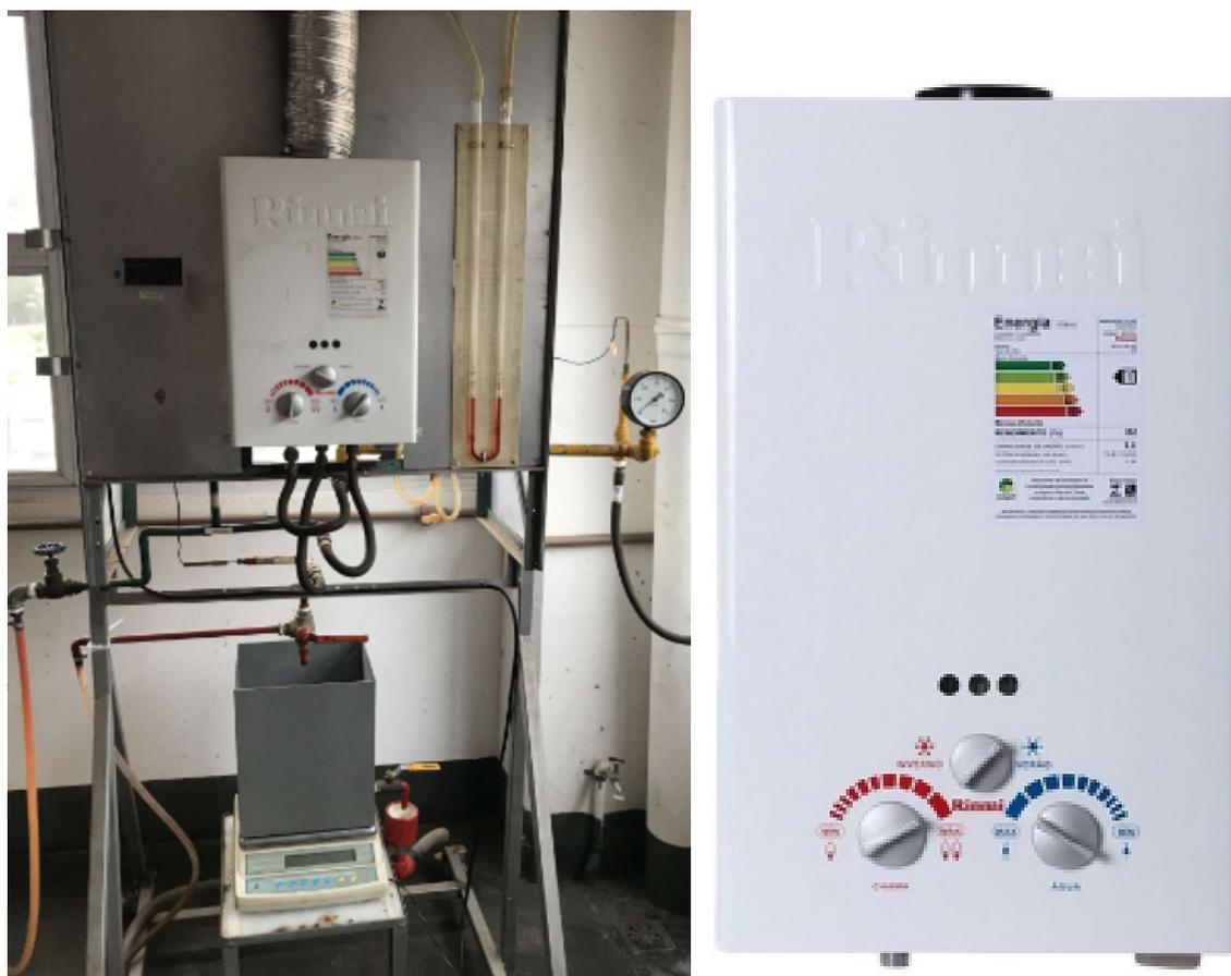
Figura 1. Fotografia do sistema experimental com detalhe para o painel do aquecedor.
