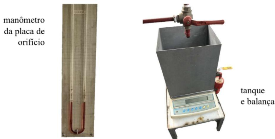
Figura 3: Métodos usados para medição das vazões de gás e de água.
