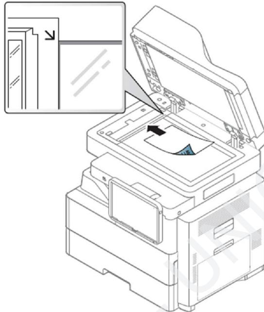
Ou na parte externa (não recomendado), posicione o(s) documento(s) a ser (em) digitalizado(s) com a face para cima, se preciso ajuste as guias como ilustrado na figura da impressora:
