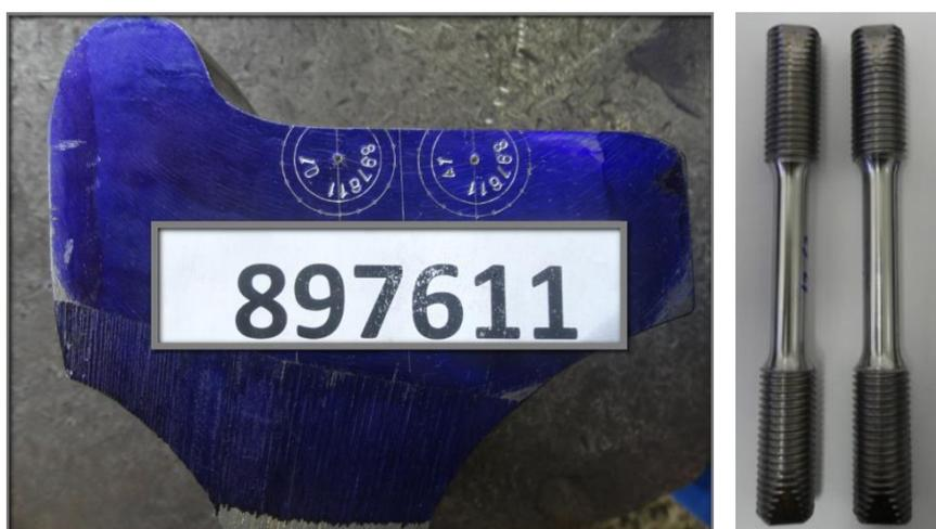
Figura 3.19: Localização dos corpos de prova de tração para ensaio a quente e à temperatura ambiente segundo AAR M107/208.
