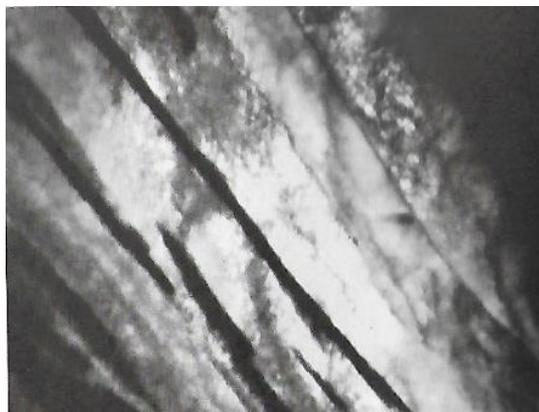
Figura 2.26: Carbonetos formados entre ripas de martensita superior no aço 4360, transformado isotermicamente a 495 °C. Microscópio eletrônico de transmissão (25.000 X) (KRAUSS, 1985).
