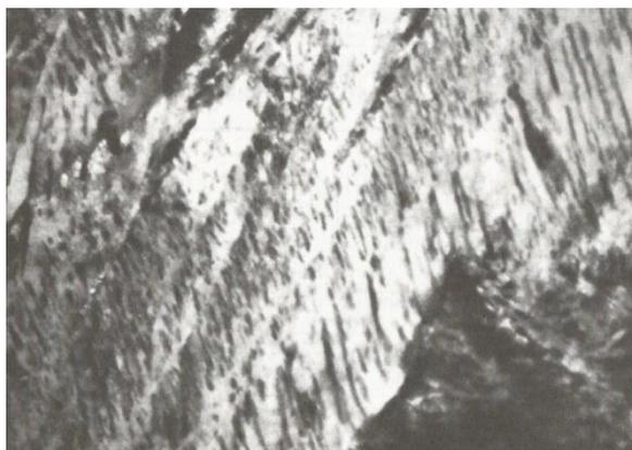
Figura 2.27: Bainita inferior com finos carbonetos entre placas no aço 4360, transformado isotermicamente a 300 °C. Microscópio eletrônico de transmissão (24.000 X) (KRAUSS, 1985).
