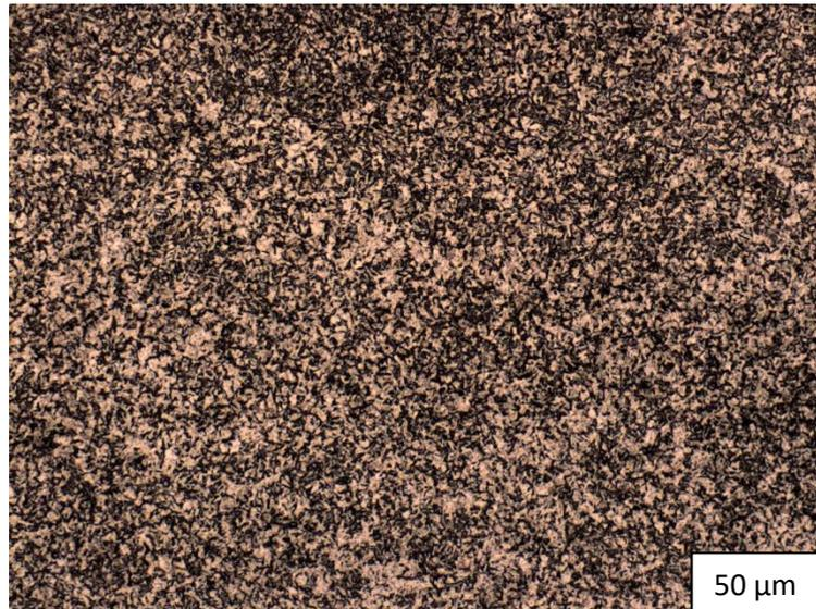
Figura 4.50: Tamanho de grão austenítico do aço Nb2 (ataque com picral).
