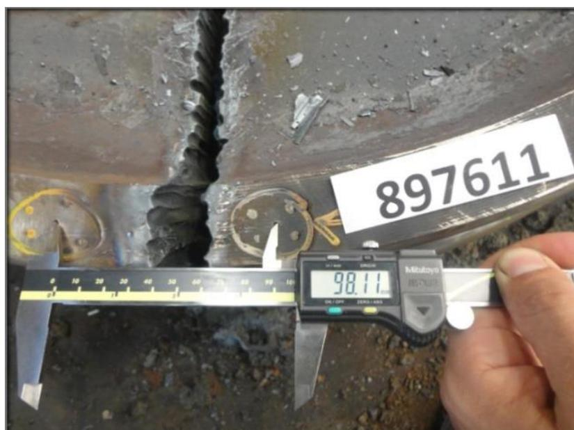
Figura 3.24: Medida do fechamento do aro após o corte e espera de no mínimo 1 hora para acomodação das tensões de compressão no aro da roda, segundo AAR M107/208.
