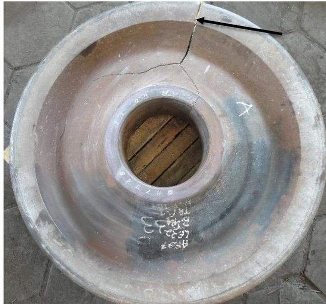
Figura 2.9: Roda com fratura por fadiga térmica devido à inversão das tensões, onde o aquecimento excessivo do aro durante a frenagem foi suficiente para transformar a maior parte da tensão de compressão, gerada no tratamento térmico, em tração provocando a fratura da roda (MINICUCCI, 2011).
