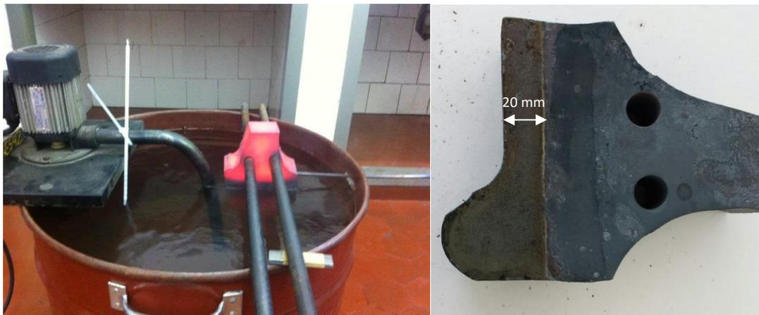
Figura 3.14: Têmpera em água das amostras em tanque com recirculador, termômetro para monitoramento da temperatura da água e hastes para nivelar a amostra (esquerda). Secção de roda mostrando a camada temperada e a profundidade de 20 mm que foi mergulhada na água, com profundidade ajustada pelas hastes de nivelamento mostradas na figura da esquerda (direita).
