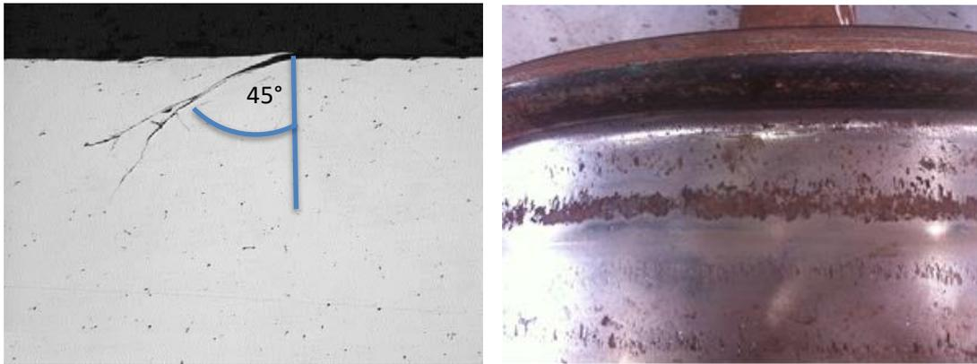
Figura 2.11: Trincas causadas por *shelling* na pista de rodas ferroviárias devido às altas tensões no contato roda trilho (STONE, 1992).
