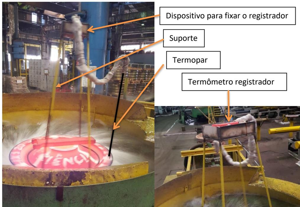
Figura 3.33: Dispositivo para coleta da taxa de resfriamento na máquina de têmpera.
