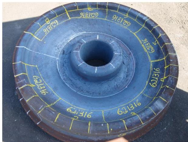
Figura 3.9: Indicação dos cortes para retirada de várias secções da roda, que após passarem por tratamento térmico (têmpera em água), com revenimento em várias temperaturas, foram cortadas novamente para retirada dos corpos de prova de Charpy.
