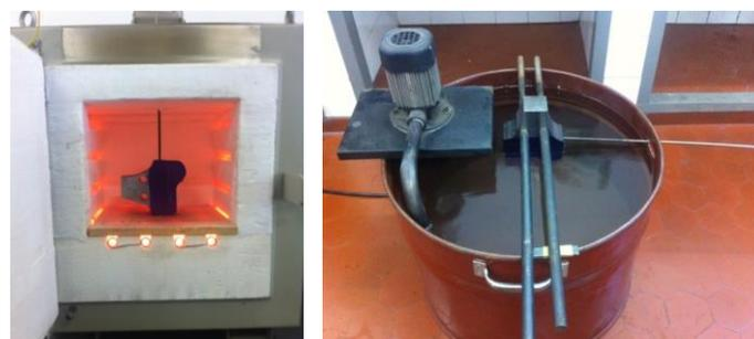
Figura 3.12: Forno mufla com secção de roda e termopar para monitorar a temperatura (esquerda). Tanque de água com recirculador e duas hastes utilizadas para nivelar as amostras durante a têmpera em água (direita).
