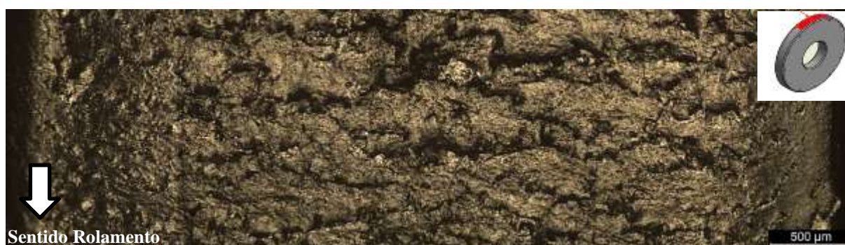
Figura 4.39 – Pista de rolamento do disco de microestrutura bainítica após 100 mil ciclos e escorregamento de 0,75 %. MO.
