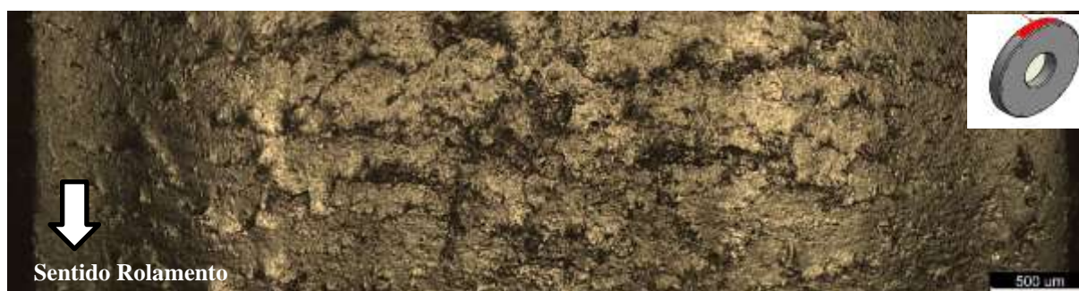
Figura 4.38 – Pista de rolamento do disco com microestrutura mista após 100 mil ciclos e escorregamento de 0,75 %. MO.
