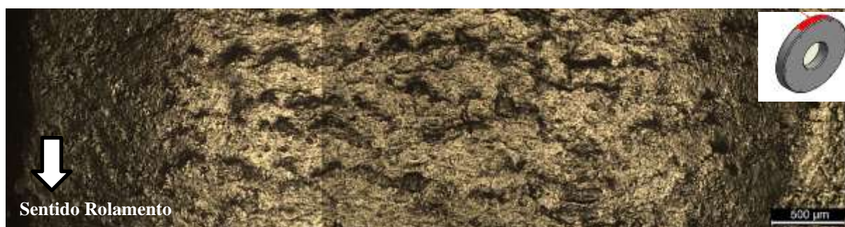
Figura 4.40 – Pista de rolamento do disco de microestrutura perlítica após 100 mil ciclos e escorregamento de 0,75 %. MO.
