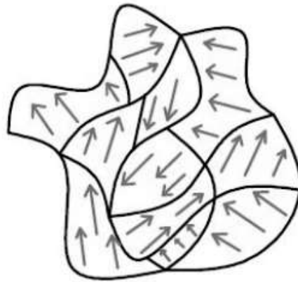
Figura 2.29 – Desenho esquemático dos domínios magnéticos em um grão de material ferromagnético (Grijalba, 2010).
