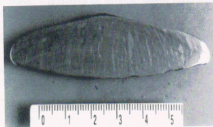
Figura 3.2 – Corte longitudinal de um disco de silício mostrando a estrutura de grãos colunares.
