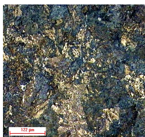
Figura 5 – Aços C6 (esquerda) e C6Nb (direita), antes da laminação. Nital 2%, 100 X.
