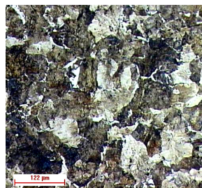
Figura 4 – Aços C5 (esquerda) e C5Nb (direita), após a laminação. Nital 2%, 100 X.
