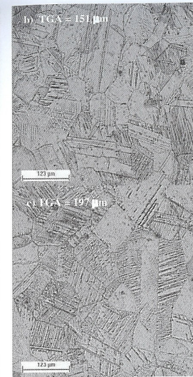
Figura 2. Microscopia óptica mostrando os diferentes tamanhos de grãos austeníticos obtidos. Reagente: 1,2 g K 2 S 2 O 8 + 0,8 g NH 4 HF 2 + 100 ml H 2 O
