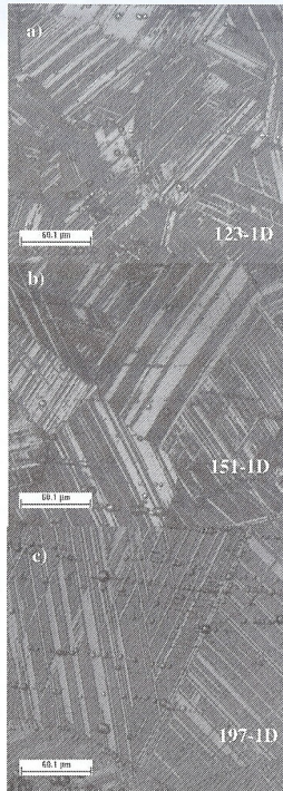
Figura 3. Microscopia óptica mostrando as placas de martensita-ε dentro do grão austenítico. Reagente: 1,2 g K 2 S 2 O 5 + 0,8 g NH 4 HF 2 + 100 ml H 2 O
