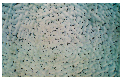
9.g: Alívio de tensões a 550°C. 50X
