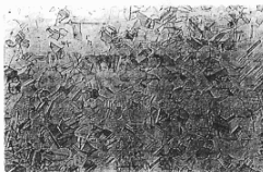
Figura 5. Seção transversal do fio diam. 5,0mm da liga CrNi recozida a 1323K/2400s. Aumento: 100X; Ataque: Gliceregia.
