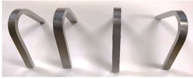
Figura 3 – Ensaio de dobramento das juntas soldadas. Da esquerda para a direita, junta A, B, C e D.
