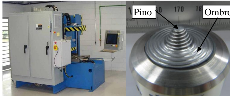
Figura 2 – a) Máquina de SAPNC. b) ferramenta de PCBN-WRe, com indicações do pino e do ombro.
