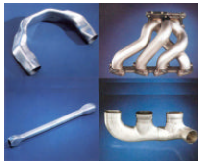
Figura 1. Peças obtidas pelo processo de hidroconformação. Metal Forming Handbook (1998).
