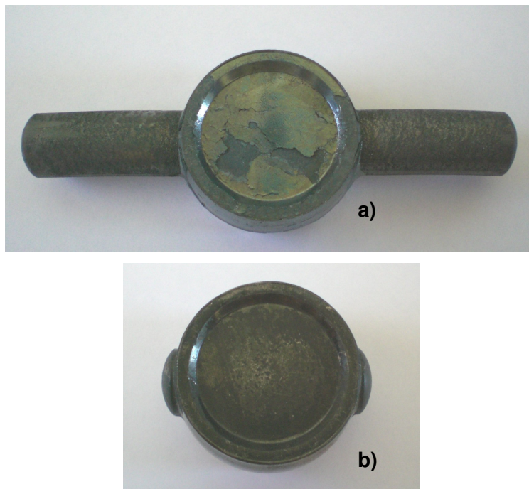
Figura 4.10 – Corpos de prova forjados no laboratório: a) a quente e b) a morno.
