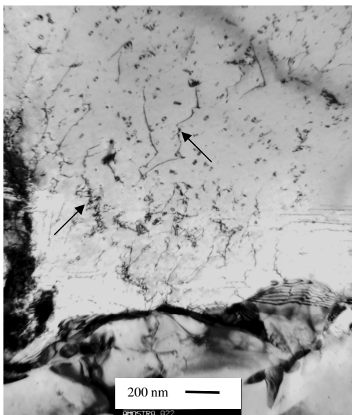
Figura 4.39 – Precipitação de carbonitretos em amostra do processo Ausforming 2 (ataque Tenupol ).
