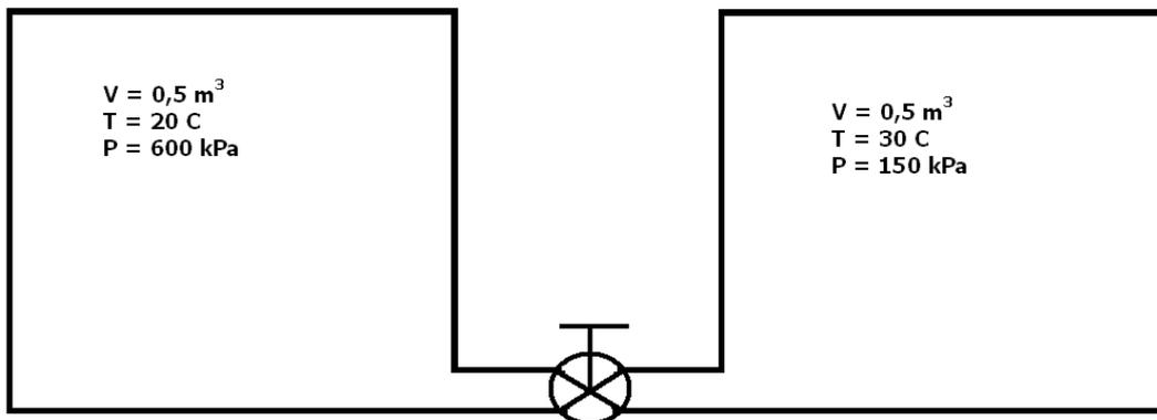
Aplicando a lei de estado para os gases perfeitos, pode-se calcular as massas dos tanques A e B antes da válvula ser aberta como:
