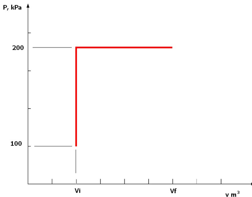
a) a temperatura inicial do sistema corresponde a temperatura de saturação na pressão de saturação, obtida na tabela como  $T_i = 99,62 \text{ C}$ . Para a temperatura final é necessário se conhecer mais uma propriedade termodinâmica uma vez que só é fornecida a pressão. Uma informação extra que é colocada no problema é que o volume final é 20% superior ao volume inicial, desta forma pode-se escrever que:
