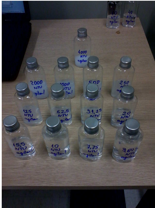
Figura 4.9: Soluções preparadas a partir da diluição da formazina 4000 NTU para calibração do turbidímetro.
