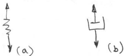
Fig. 8 - Representação esquemática do comportamento ideal de um fluido viscoelástico linear: a) Mola Hookeana; b) Amortecedor Newtoniano.
