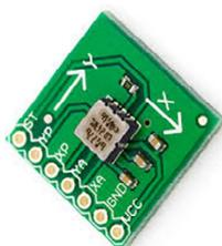
Figura 2.4. Circuito contendo um acelerômetro de capacitor com dimensões reduzidas. Fonte: <https://multilogica-shop.com> em 05/09/15
