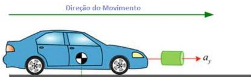
Figura 3.4. Direção de aceleração  $a_{lin,y}$  do celular coincidente com a direção de movimento do veículo. Fonte: Adaptado de [2]
