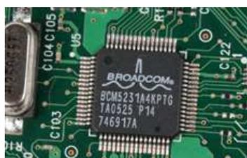
Figura 2.11. Placa de circuito impresso contendo um receptor de sinal GPS. Fonte: [www.androidheadlines.com](http://www.androidheadlines.com) em 11/10/15
