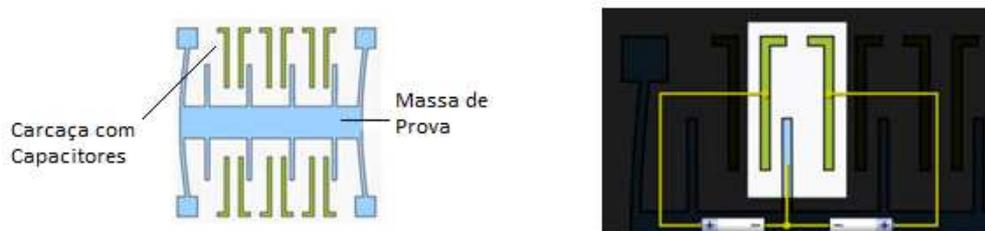
Figura 2.3. (E): Caracterização dos elementos de um acelerômetro de capacitor; (D): Princípio de funcionamento do dispositivo. Fonte: Adaptado de <http://www.decom.ufop.br/> em 05/09/15
