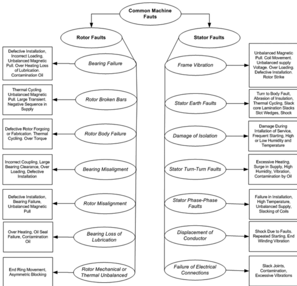
Figura 1. Falhas comuns e suas causas em motores de indução
