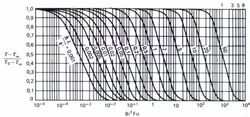
Figura 8-20 Temperatura da superfície adiabática — placa infinita,  $X = 0$ . Usada com permissão.<sup>12</sup>
