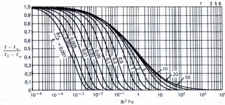
Figura 8-24 Temperatura na superfície — cilindro infinito,  $R = 1$ . Usada com permissão.<sup>12</sup>
