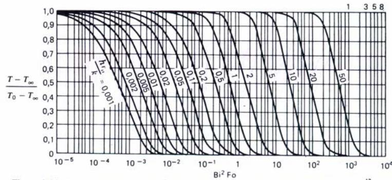
Figura 8-23 Temperatura na linha de centro — cilindro infinito,  $R = 0$ . Usada com permissão.<sup>12</sup>
