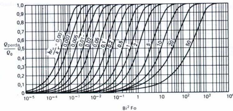
Figura 8-25 Calor perdido — cilindro infinito. Usada com permissão.<sup>12</sup>
