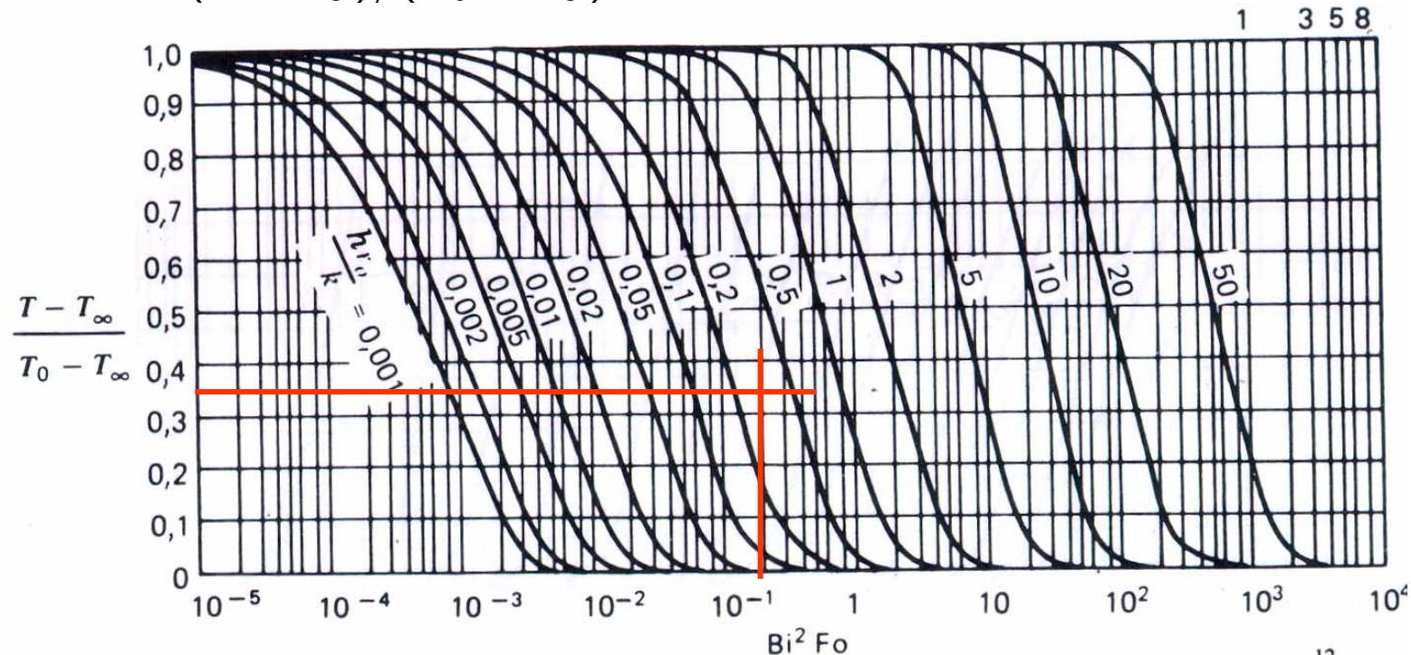
Figura 8-23 Temperatura na linha de centro — cilindro infinito,  $R = 0$ . Usada com permissão.<sup>12</sup>
