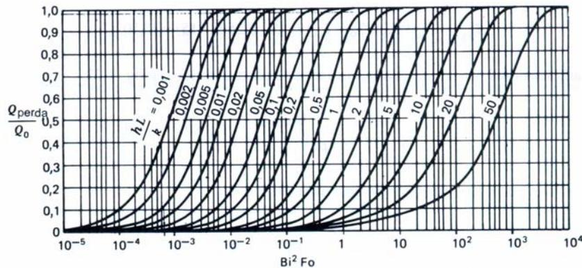
Figura 8-22 Calor perdido — placa infinita. Usada com permissão.<sup>12</sup>
