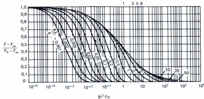
Figura 8-21 Temperatura de superfície — placa infinita,  $X = 1$ . Usada com permissão.<sup>12</sup>
