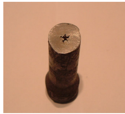
Figura 2.12: Defeito tipo “rechupe” Figura 2.13: Defeito tipo cavidade central
