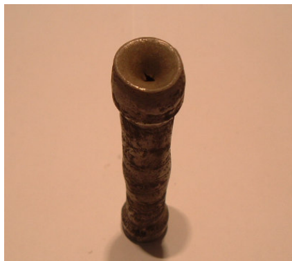
Figura 2.12: Defeito tipo “rechupe” Figura 2.13: Defeito tipo cavidade central
