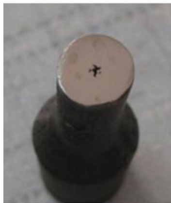
Figura 13. Defeito em pré-forma obtido por laminação transversal com cunha (JI et al. , 2015).
