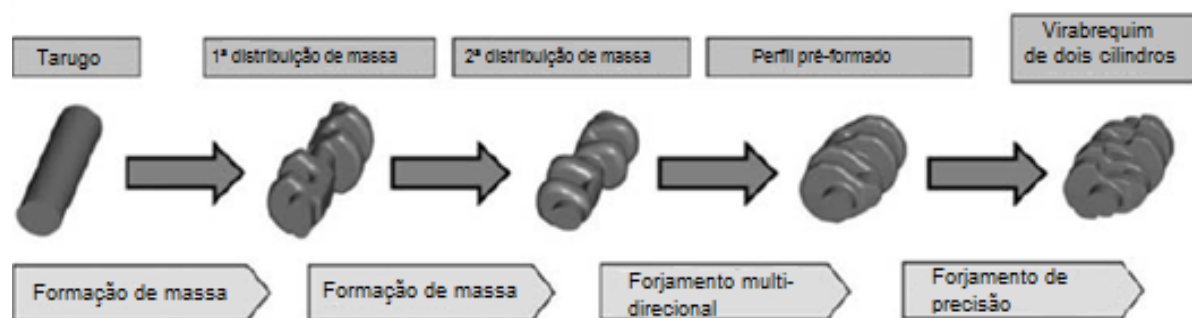
Figura 6. Sequência do forjamento para o virabrequim de dois cilindros (Adaptada de BEHRENS et al. , 2009).
