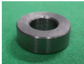
Figura 31. Corpo de prova utilizado nos ensaios de anel.
