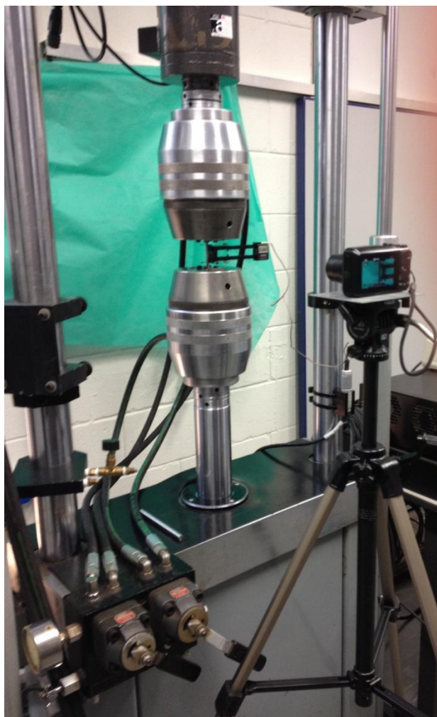
Figura 4.2 – Arranjo experimental durante a documentação dos ensaios.
