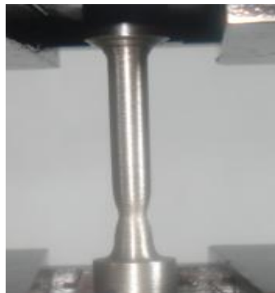
Figura 2.6 - Estringimento de um corpo-de-prova antes da fratura.
