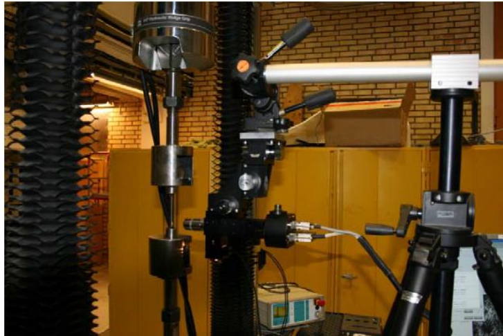
Figura 2.24 - Esquema para obtenção das imagens DIC.
