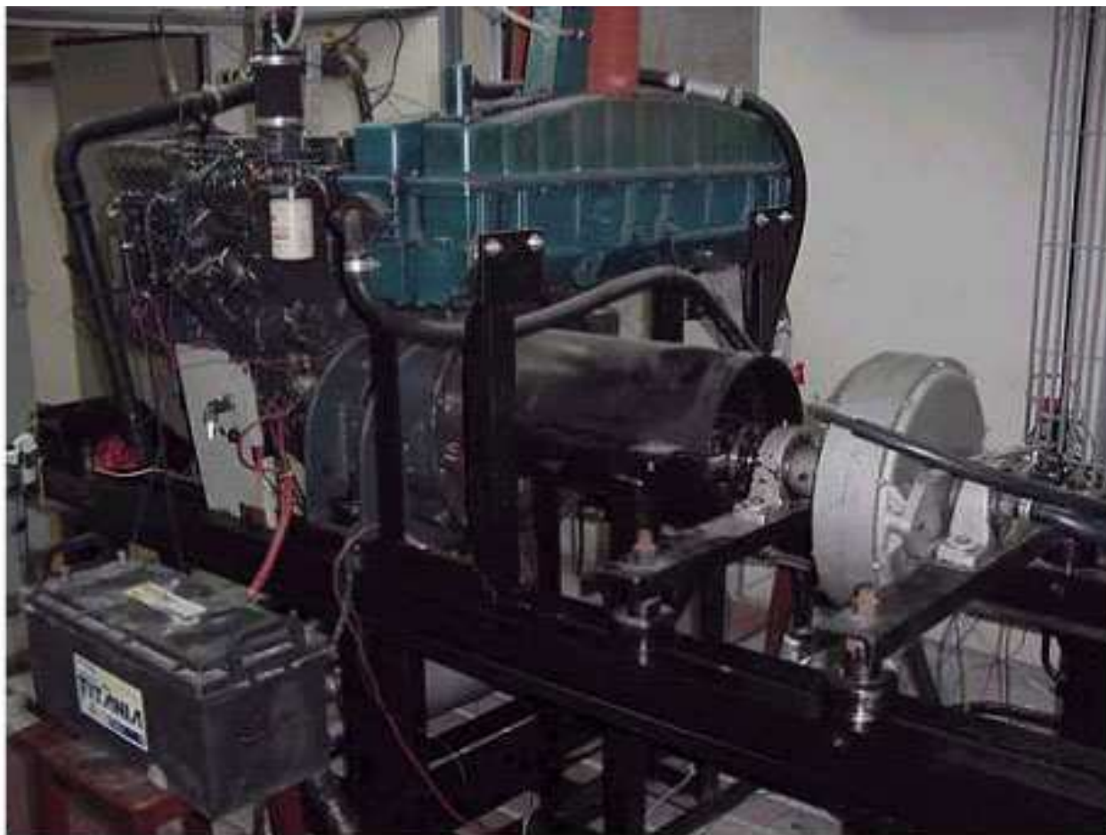
Figura 1 – Motor Cummins instalado em bancada dinamométrica no LMT
